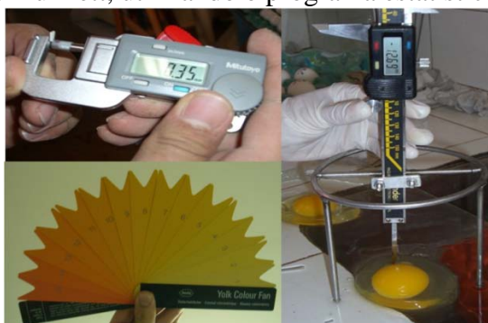
Figura 1. Instrumentos utilizados para análise de qualidade de ovo: micrômetro digital (espessura da casca), paquímetro digital (altura de albúmen) e leque colorimétrico (coloração da gema)
